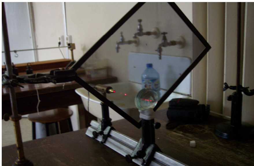
Rys. 31 Stół laboratoryjny z laserem, siatką od monitora i soczewką tuż za siatką.
