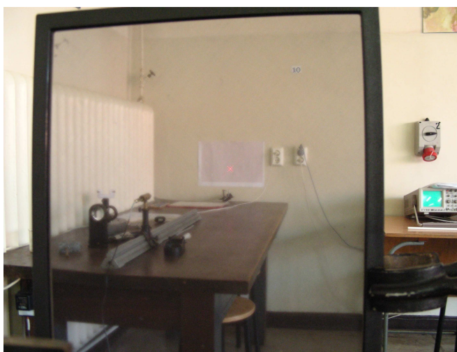
Rys. 7 Obraz stołu laboratoryjnego z szyną optyczną na której zamocowano laser widziany przez siatkę „ochroną” od komputera. Po prawej stronie powiększenie wykonanego zdjęcia.
